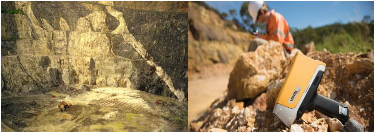
Figura 1. À esquerda: a pegmatita LCT Li-Ta-Sn Greenbushes de alto nível no Oeste da Austrália. À direita: um analisador portátil por XRF Olympus Vanta™ sendo usado para exploração mineral geoquímica.
